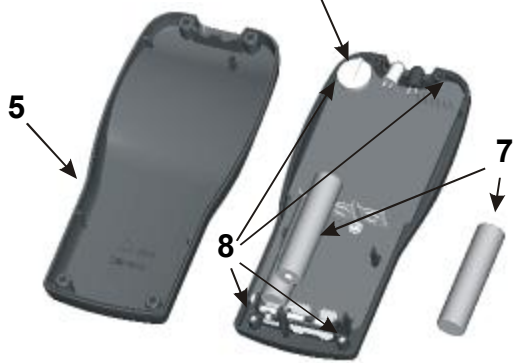
Figura 2: Baterías S300RPTU Baterías necesarias: 3 x 1,5V LR03 (AAA)
